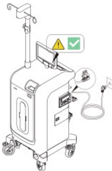
Abb.14 Anschließen der Stromversorgung
