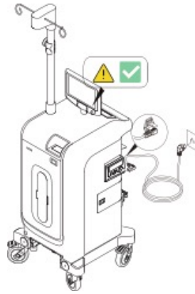
Abb.19 Anschließen der Stromversorgung
