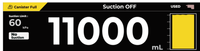
Abb.28 Zustand „Behälter Voll“ (Anzeige des sekundären Bedienfelds)
