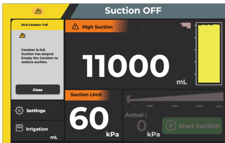
Abb.27 Zustand „ Behälter Voll“ (Hauptbedienfeldanzeige)
