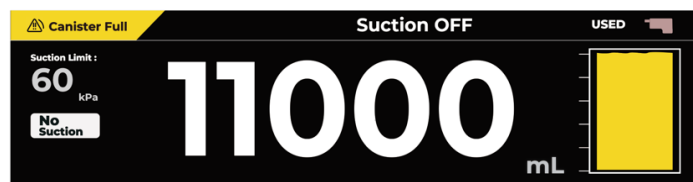
Figura 22 Condición de recipiente lleno (Pantalla del Panel de Control Secundario)
