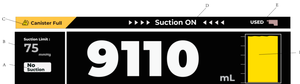
Figura 6 Ecrã do Painel de Controlo Secundário (rondando)
