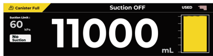
Figura 22 Condição de Recipiente Cheio (Mostrador do Painel de Controlo Secundário)
