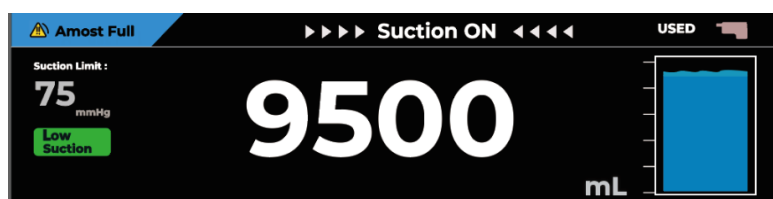
Figura 20 Condição de Recipiente Quase Cheio (Mostrador do Painel de Controlo Secundário)
