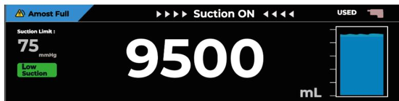
Abb.26 Zustand „Behälter Fast Voll“ (Anzeige des sekundären Bedienfelds)
