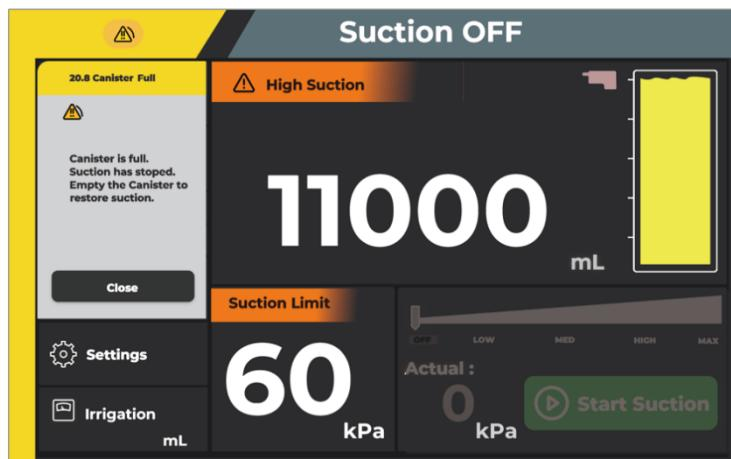
Abb.27 Zustand „Behälter Voll“ (Hauptbedienfeldanzeige)
